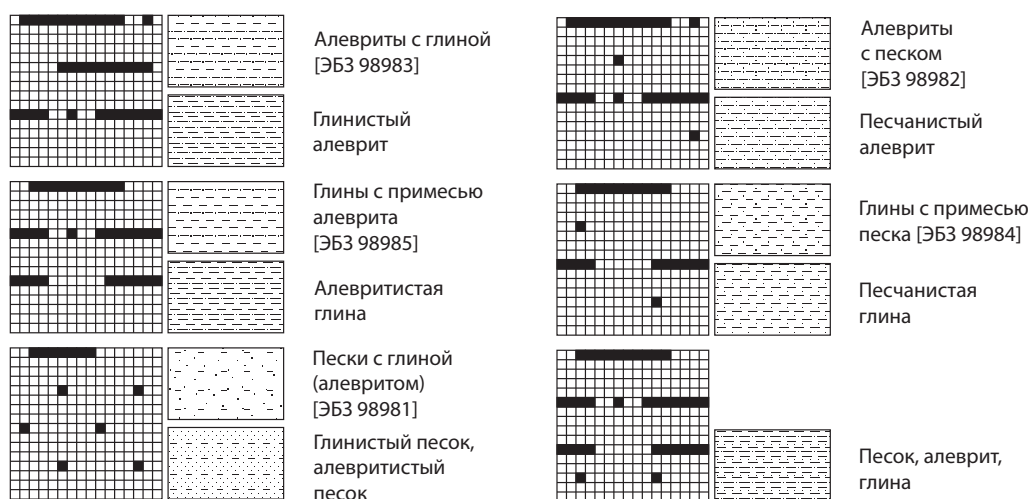
Рис. 6. Крапы и цветовая модель RGB смешанных литотипов для работы с терригенными отложениями
