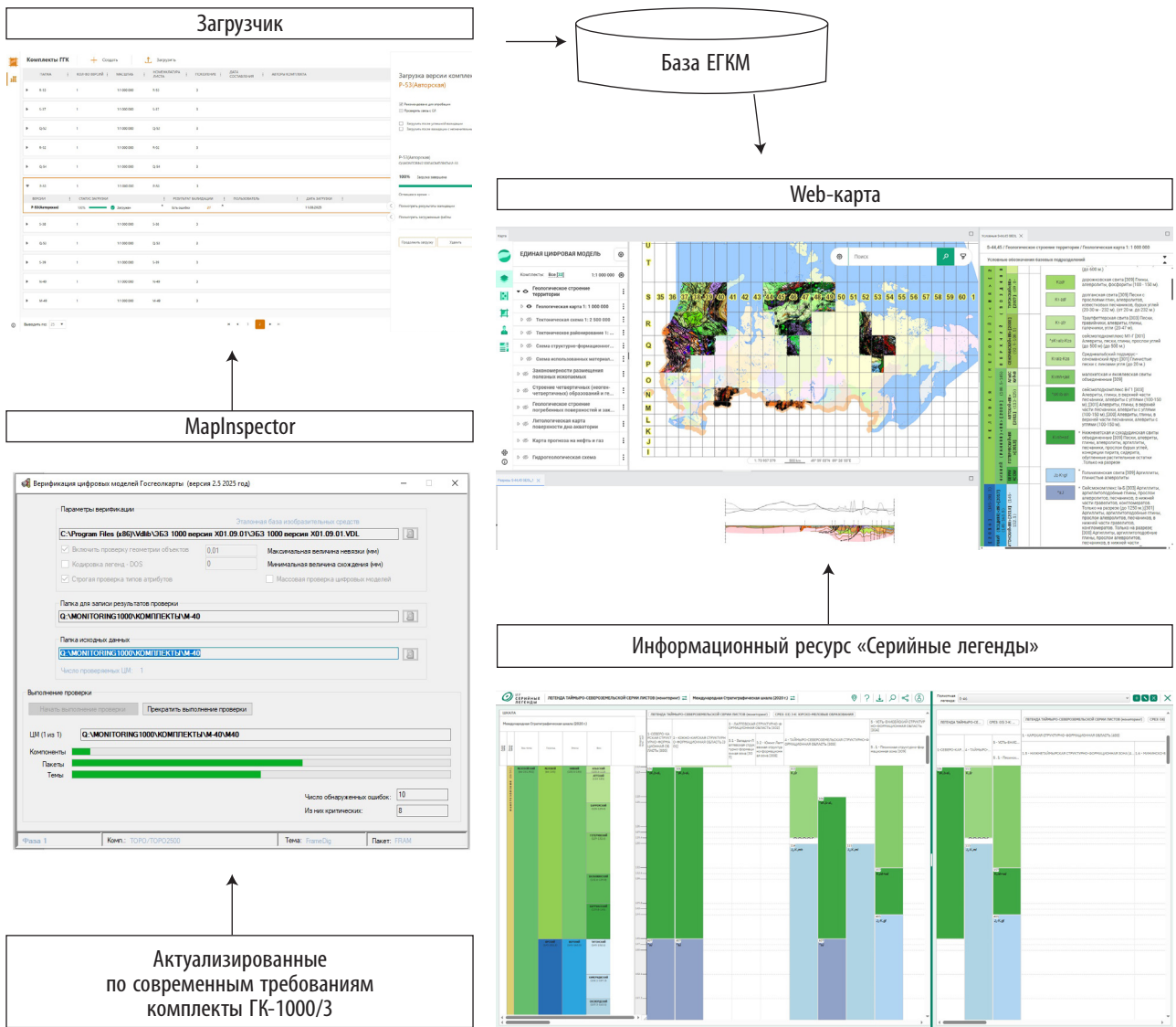
Рис. 1. Схема работы с картографическими данными Fig. 1. Cartographic data flow chart
