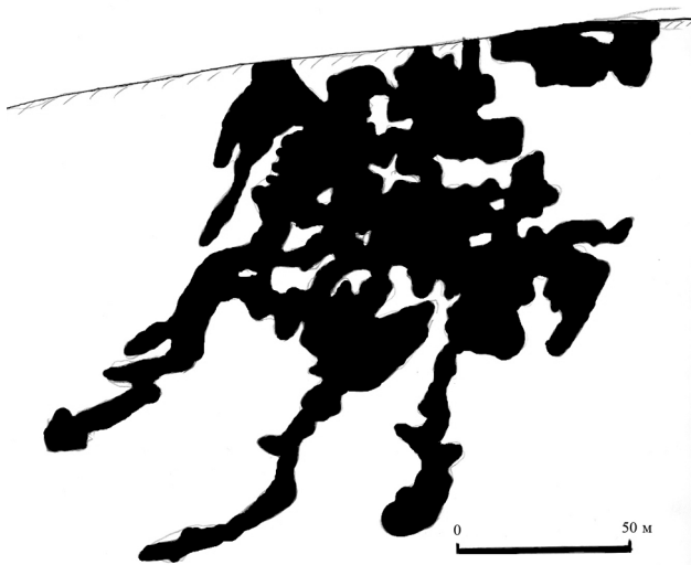
Рис. 4. Сечения отработанных богатых гидротермокарстовых свинцово-цинково-рудных залежей Воздвиженского месторождения Восточного Забайкалья (по С. С. Смирнову, 1961) [11]
