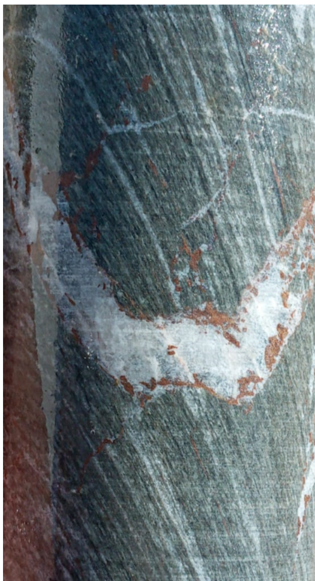
Рис. 3. Керн. Алевроаргиллит с кварц-кальцитовыми разноориентированными прожилками с гнездами сфалерита
