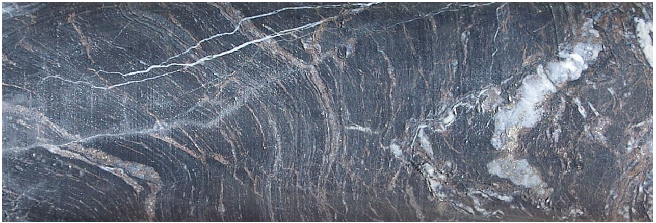
Рис. 4. Керн. Характер плейчатости в углеродистых алевроаргиллитах, подчеркнутой сингенетичной пирит-пиротиновой минерализацией
