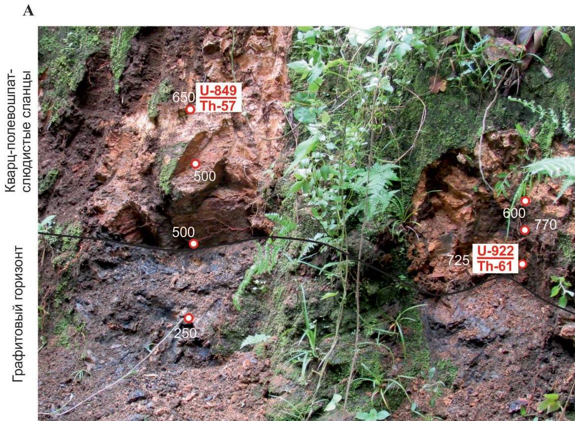
Рис. 2. Характер залегания графитонесущих пород с данными гамма-спектрометрии. Максимальная радиоактивность показана в точках измерения, в марке – содержания U и Th в ppm
