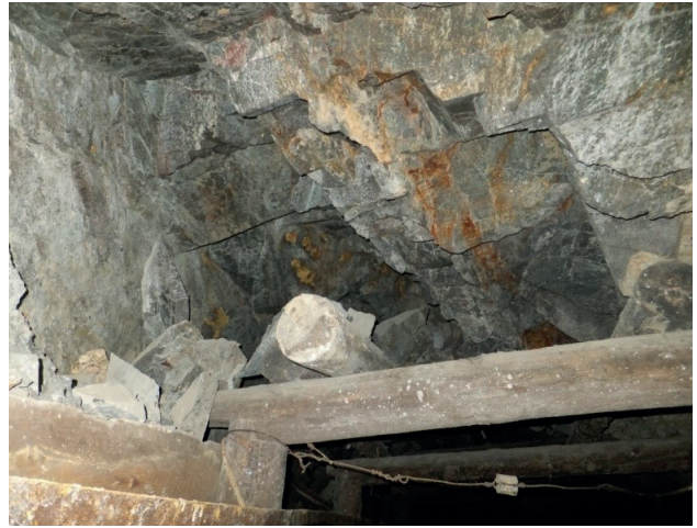
Рис. 2. Обрушения по контактам напластования раздробленных пород на кровле горных выработок с захватом левой стенки
